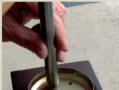
Zusammenbau der Einzelteile durch Anbringen der Federmuttern.
