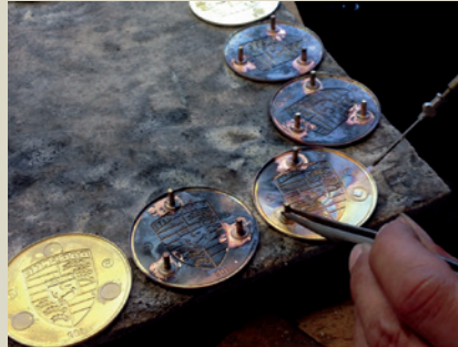
Hartlöten der Stifte nach Ausstanzen der Platine.
