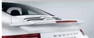
Der Spaltflügel am Heck verfügt in der jüngsten Generation über drei ansteuerbare Positionen.
